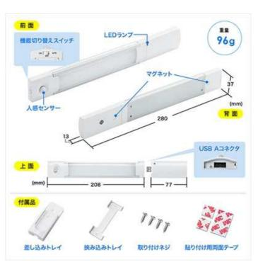
本製品は、便利な USB 充電式で暗所で使用できる人感センサー搭載の LED ライトです。機能切り替えスイッチを AUTO モードに設定することで、暗所の場所で人感センサーが人の動きを感知、自動で点灯し、点灯後約 20 秒後に消灯する省エネ設計になっています。本体は着脱可能な一体型バッテリーとなっており、充電用 USB コネクタをそのまま USB ポートへ直接挿し充電ができるので、電池交換やケーブルは必要ありません。筐体は 800-LED019 が大型タイプ、800-LED020 が小型タイプで、環境に合わせて大きさを選ぶことができます。両製品ともにマグネット取り付けが可能で、付属パーツの差し込みトレイ、挟み込みトレイを使用することでクローゼットや廊下などに取り付けることが可能です。0N モー
