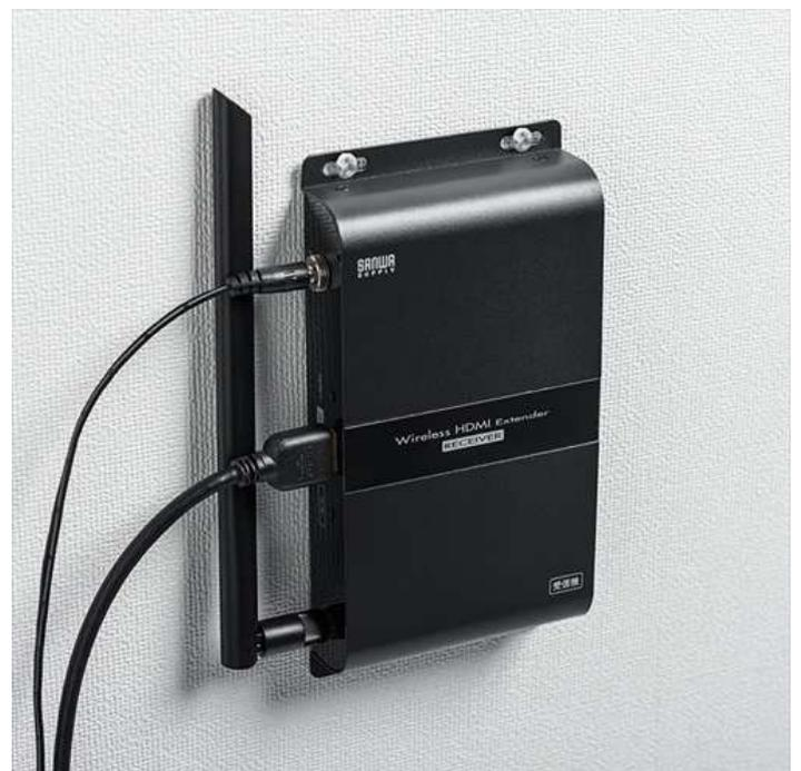
本製品は、HDMI 信号をワイヤレスで最大 150m 先まで伝送可能なワイヤレス HDMI エクステンダーです。パソコンやレコーダーなどの HDMI 機器と、テレビやプロジェクターなどの出力機器に送信機、受信機を接続するだけで使用できます。電波干渉が少ない 5GHz 帯のワイヤレス通信で最大 150m 先まで伝送が可能です。大きな講堂や体育館など広い会場で使用するには、配線不要で、映像をテレビやプロジェクターに映すことができとても便利です。※障害物がある場合は、伝送距離が異なります。3D 映像やフルハイビジョン高画質映像にも対応しており、音声もクリアに伝えることができます。IR 送信機、IR 受信機を搭載している為、赤外線リモコン信号もワイヤレスで送受信でき、離れた場所にいたまま送信機側の機器を操作することが可能です。筐体は、スチール製で壁面に取り付ける為のネジ穴も搭載しているので、別途ネジを使用することで、壁面への取り付けもでき、スッキリした見た目です。
