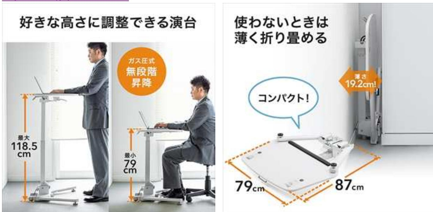
本製品は、折りたたみ収納が可能な上下昇降デスクです。足元のペダルを踏むことで天板高さを790mm～1185mmの間で調整することができ、天板下のレバーを調整することで天板角度をフラットな状態から下へ90°調整することができます。天板サイズもW790mm×D480mmと広くA4見開きを余裕で置ける大きさです。普段の上下昇降デスクとして使用するだけでなく、譜面台や絵画用など、天板の高さ調整や角度調整を生かして様々なシーンで使用することが可能です。またキャスターを後方へ2つ装備しているので、ちょっとした位置調整や移動もスムーズに行うことができます。
