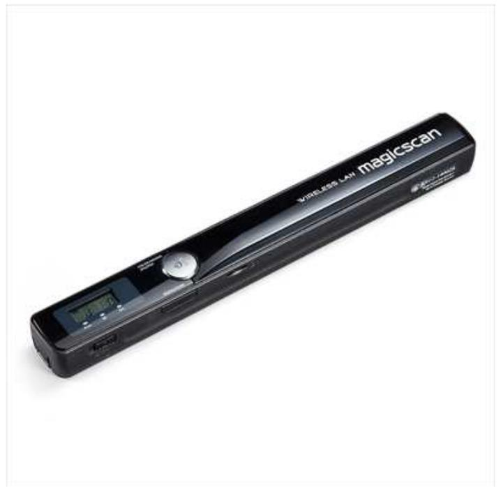
本製品は、スマートフォンとケーブルを繋ぐことなく単体でスキャン可能な、ケーブルレスのハンディスキャナーです。Wi-Fi 経由で iPhone 等のスマートフォンとワイヤレスで接続し、専用アプリで手軽にスキャン可能です。スキャンデータはダイレクトに転送されるので、すぐに確認、データ化が可能です。またスキャンしたデータはアプリ経由でメール添付やスマートフォン本体にも保存が可能です。スマートフォンへの接続以外にも、専用ソフトを使用してパソコンへの接続も可能です。また専用ソフトを使用して、スキャナにデータを保存せずパソコンへ直接データを転送したり、Excel や Word へスキャンした画像をそのまま貼り付けが可能です。PC ソフト限定で、OCR 機能を搭載しているのので、文字のデータ化も可能です。またスマートフォンやパソコンを使用しなくても、本体の microSD カードにスキャンデータを保存できるので、場所を選ばずスキャンすることができます。
