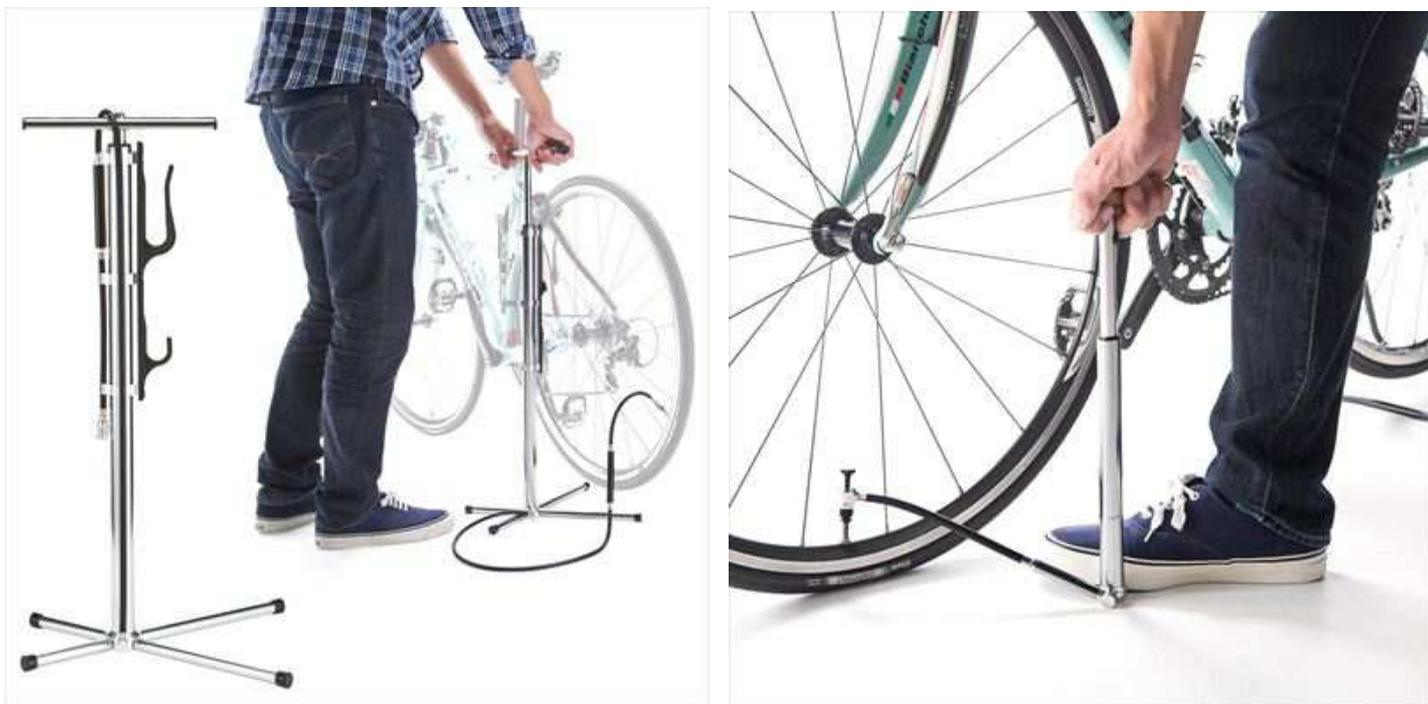
本製品は、仏式バルブ、米式バルブに対応した自転車用空気入れです。800-BYPUM3 は自転車を掛けられるフックが搭載されており、スタンドを別で用意する必要がなく、自転車を立てての空気の注入が1台で行えます。ツインヘッドバルブを採用し、接続部分をひっくり返すことで仏式、米式の切替えが行えます。ホースの途中にエアゲージが搭載されているので、空気圧の管理が一目で行えます。800-BYPUM4 はボトルケージに取り付け可能な携帯用ポンプです。通常の携帯用ポンプは片手で本体を支えてもう片方の手で圧力を掛けるものが多く、腕の力が必要でした。本製品はフットステップ付きなので、足で固定して腕の力だけでなく体重をかけやすいので、空気の注入が楽に行えます。
