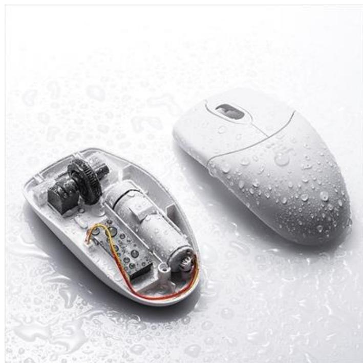
本製品は、防水防塵規格 IP68 を取得したワイヤレスマウスです。IP68 を取得しているため、汚れても水洗い可能で、また、ホコリが多いところでも使用できます。さらに、抗菌仕様なのでいつでも清潔で公共の場でお使いいただけます。クリック音が約 30db と非常に静かで、従来のマウス（約 55db 程度）に比べて約 100 分の 1 の音響パワー（10 分の 1 の音圧）になります。波長の長い赤外線 LED を使用する IR センサーを搭載しており、駆動電圧を低くし低消費エネルギーで使用する事ができます。対称形で使いやすい、シンプルなワイヤレスマウスです。レシーバーはマウス本体電池カバー内に収納できるので安心です。※レシーバーは防水・防塵ではありません。1600 カウントのカーソルスピードの為、手首一振りでも画面の端まで移動する事ができます。開梱しやすく、開梱後のゴミを減らすことができる紙箱パッケージです。
