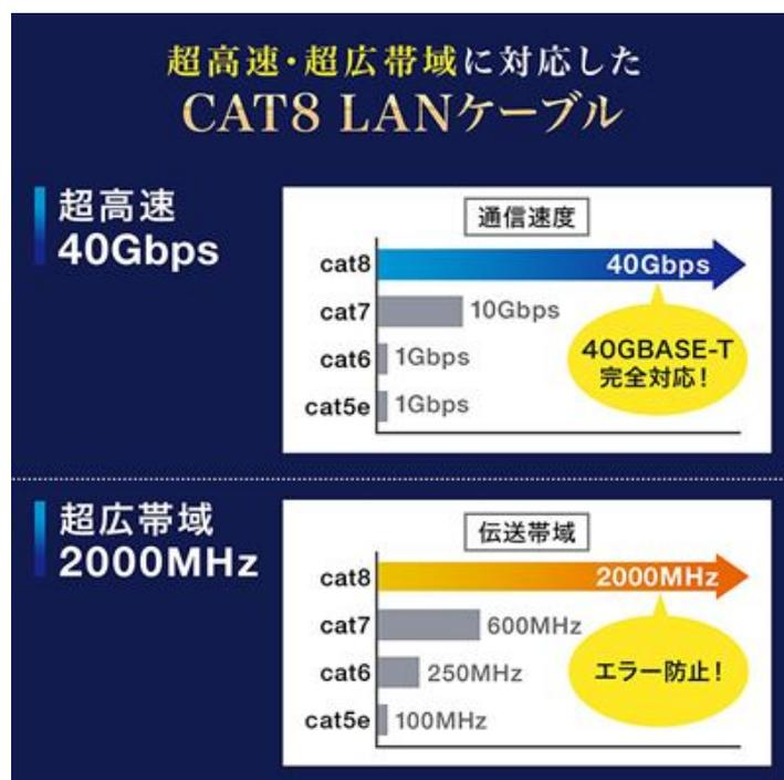
本製品はカテゴリー8に対応したフラット型LANケーブルです。次世代イーサネット40GBASE-T（40Gbps）、25GBASE-T（25Gbps）に完全対応しています。超広帯域2000MHzの伝送帯域を確保しており、データエラーを防止して安定したネットワーク環境を提供することが出来ます。ペアごとにシールドを施しているフラットケーブルなのでノイズをしっかり防ぐことが出来ます。サーバーラック内等LANケーブルが多く併設する場所でもノイズの影響を受けにくい構造です。取り回しがしやすいフラット形状のケーブルです。コネクタ部のツメが折れにくいように弾力性に優れたPVC製のツメ折れ防止カバーを採用しています。高精度の接触を保証する金メッキシールドプラグを採用しています。
