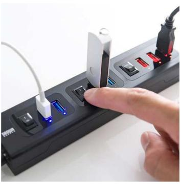
本製品は、USB3.0 対応のセルフパワー専用 USB ハブです。USB3.0 対応なので、USB2.0 の約 10 倍(理論値)の転送速度 に対応しています。USB 機器接続ポートを 4 ポート、スマホやタブレット等の充電ができる充電専用ポートを 3 ポート 搭載しています。従来別々に使用していた USB ハブと USB 充電器が 1 つになっているので、机上をすっきりと整理整頓 することができます。充電専用ポートは、1 ポート最大 2.1A、3 ポート合計最大 4.1A まで出力が可能です。
