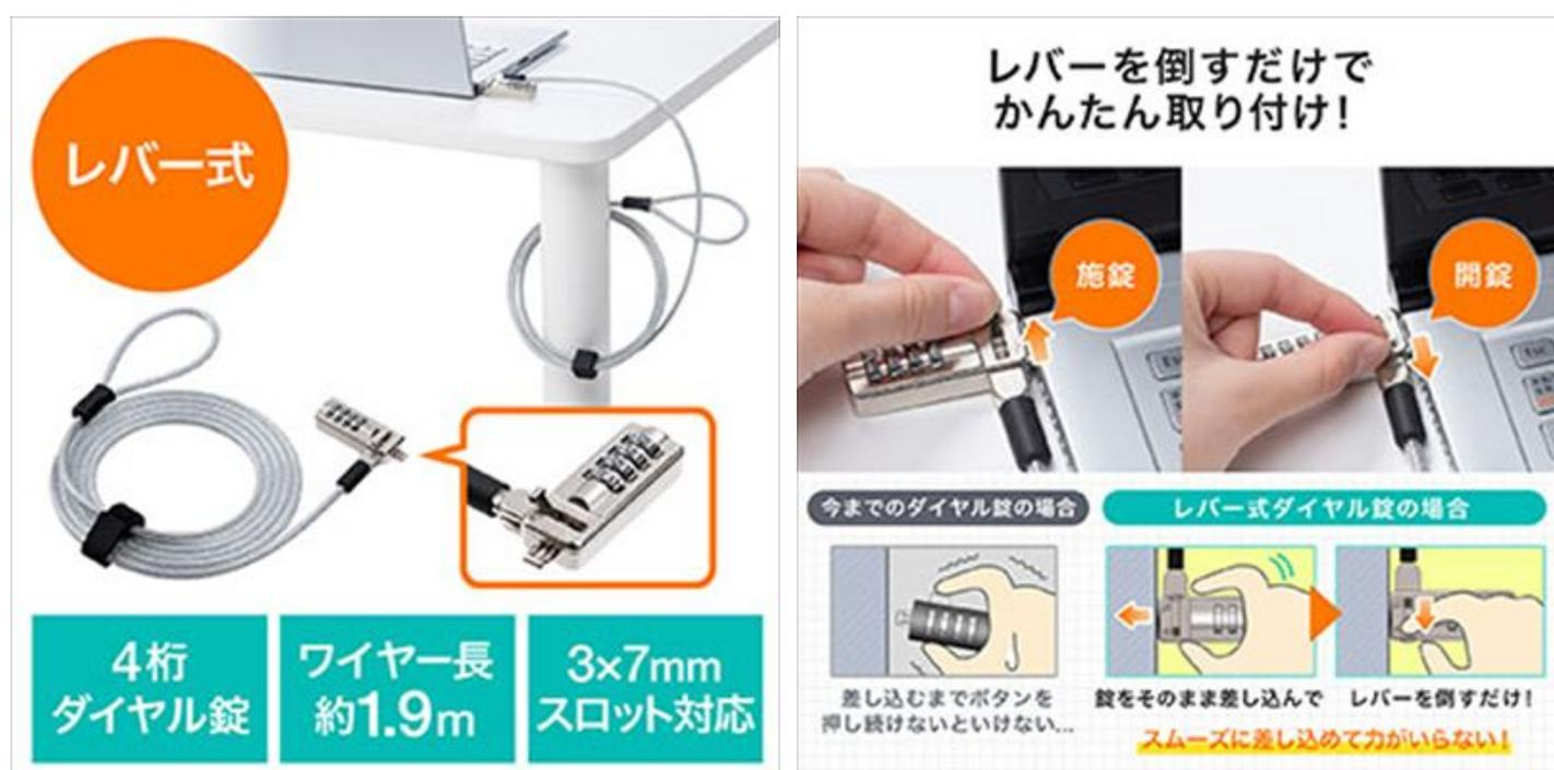
本製品は、3×7mmのセキュリティスロットに対応した、レバー式セキュリティワイヤーです。鍵をセキュリティスロットに差し、レバーを倒すだけで簡単に取り付け、盗難防止をすることができます。4桁のダイヤル式となっており、好きな番号や共有する番号に設定ができます。ダイヤル式なので、個別でカギを保管する必要がなく、カギの紛失の心配なく手軽に使うことができます。ワイヤー直径は取り回しがしやすい約5mmで、ワイヤー長は約1.9mとなっています。ワイヤー表面にはビニールコーティングがされており、機器への取り付けや取り回しの際、傷や破損を防ぎます。ワイヤーをしないときは、付属の結束バンドを使うことでコンパクトに収納ができます。また、ワイヤーを取付ける時にがたつく場合は、付属のスペーサーを使うことで調整も可能です。
