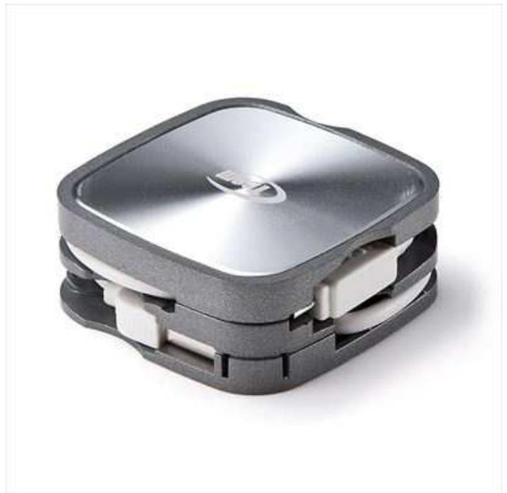
本製品は、パソコン・タブレット・スマートフォンで microSD カードのデータ転送が可能なカードリーダーです。本体に USB ケーブルとマイクロ USB ケーブルを内蔵しており、パソコンではもちろんのこと、USB ホスト機能に対応したスマホ・タブレットで microSD カードのデータを読み込むことができます。ドライバは不要で、スマホ・タブレットやパソコンに接続するだけですぐに使用できます。microSD カードスロットが内側にあるので、microSD カードがはみ出さず、引っ掛けて破損するといった恐れがありません。
