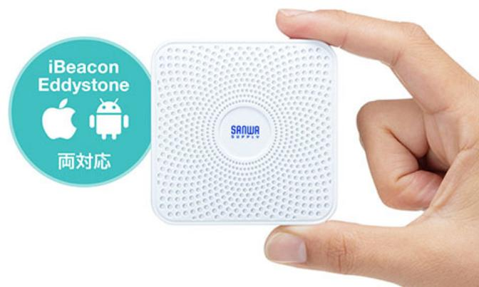
iBeacon・Eddystoneに対応したBLEビーコンです。最大で6スロット同時発信するマルチアドバタイズが可能です。6スロットを同一データフォーマットで発信することも、全て異なったデータフォーマットや使用したいデータフォーマットのみで設定することも可能です。IP66の防塵・防滴性があります。電源ON・OFFが可能ですので無駄な電池消費を抑えます。送信範囲は数m～100m以上の間で8段階設定が可能です。電波発信のインターバルは100～5000msから選択可能です。単三乾電池採用で最長10年動作します。パスワード保護機能と遠隔操作停止モード機能でセキュリティ対策も安心です。設定はAndroid・iOS用の専用アプリで設定変更が可能です。
