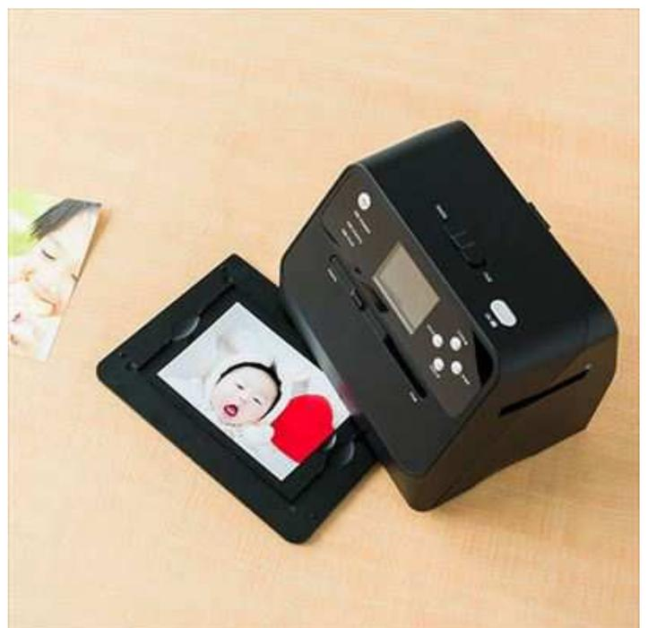
本製品は、昔撮影した写真やネガフィルム、ポジフィルムをスキャンしデータとして保存できる、写真・フィルムスキャナーです。プリントした写真やネガフィルムは、長年放置するとカビなどの劣化が起こります。本製品を使用し、データとしてパソコンなどに保存することにより、思い出の写真やフィルムを劣化から守ります。
