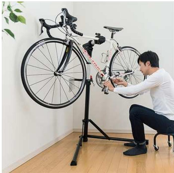
本製品は、ロードバイクやクロスバイクをメンテナンスするためのスタンドです。自転車固定はクランプ式で簡単に着脱する事が出来ます。高さは100cmから159cmまで無段階で変更でき、立ったままや座ったままなど姿勢に合わせて作業をする事が出来ます。スタンドの各種調整はクイックレバーで簡単に設定でき、角度を360°、高さ調整もワンタッチで可能です。脚はL字型で壁面やコーナーへ寄せ設置することが出来ます。対応する自転車フレームサイズが約2.5～5cmまでの太さに対応しておりロードバイクやクロスバイクに対応しています。中央部にネジなどを吸着できるマグネット内蔵の工具トレイ付きです。また、ハンドルのぐらつきを防ぐハンドル支えレバー付きです。不使用時はコンパクトに折りたたむことが出来ます。
