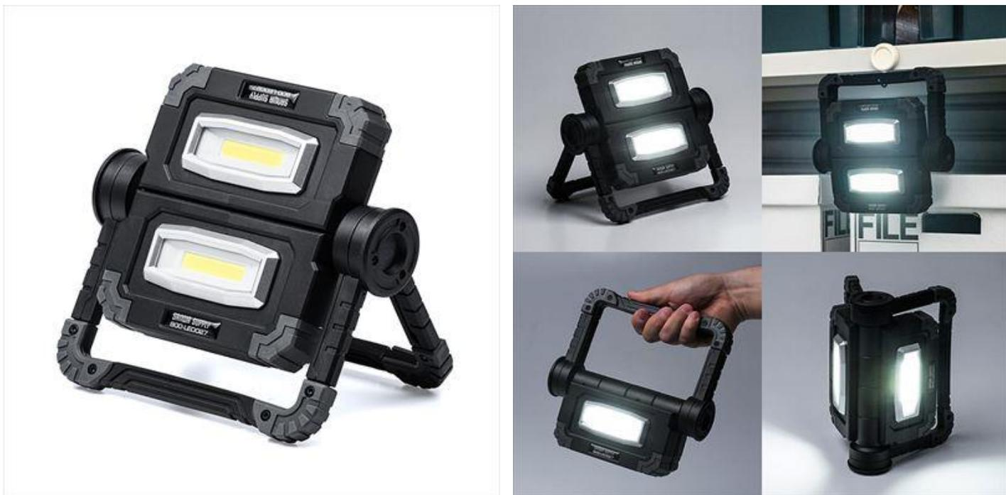
本製品は、暗闇を強力に照らすバッテリー内蔵の、USB 充電式 LED 投光器です。COB チップの面発光 LED を 2 灯使用し、最大 850 ルーメンの明るさがあります。LED の点灯はスイッチの操作で 2 灯、1 灯選択可能で、2 灯で明るくしたり、いずれか 1 灯だけを照らすこともできます。ハンドル部は約 300 度、LED 部も 90 度稼働でき、状況に合わせてスタンド、吊り下げ、手持ち、横置きから選択できます。内蔵バッテリーの残容量がわかる、LED ランプ付きです。電池や配線不要の USB 充電式で、5V/1A 充電の場合約 6 時間で満充電できます。バッテリーが満充電の場合、LED1 灯点灯時最大約 8 時間、2 灯点灯時最大約 4 時間連続使用できます。バッテリーを充電しながら使用可能で、バッテリー残量を気にせず使用できます。5V/1A 出力可能な給電用 USB ポート搭載で、別途ケーブルを用意すれば iPhone などのスマートフォンを充電できます。重量は約 460g と軽量なので、持ち運びしやすいです。
