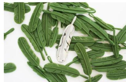
(※)ワックスとは、シルバーアクセサリの製造工程「 casting 」に用いる、ロウのこと。融点の高い油脂状の物質で、爪などで削れるほど軟らかく滑らかな固体。
