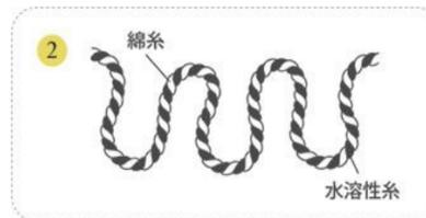
綿糸に水溶性糸(※1)を合わせ、1000回以上撚ります。その後、パイルとして織り込みます。
