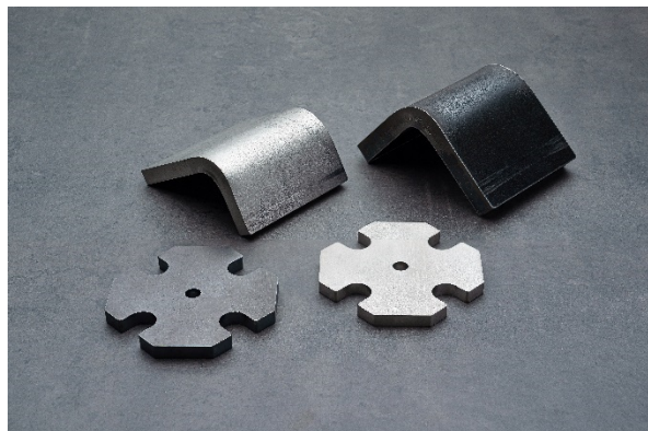
(左上から時計回りに)SUS304 (No.1)12mm、SS400 16mm、 SUS304 (No.1) 9mm、SS400 10mm
