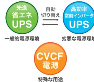
常時インバータの高い信頼性と、常時商用方式の省エネ性能を兼ね備えた、今までにないエコモード方式を採用(特許出願中)。電源環境の変化を常に監視し、電圧変動の少ない環境ではインバータを停止させ、常時商用運転に自動的に切り替えます。入力電圧が規定値の範囲を外れた場合は自動でインバータを作動させ、給電品質優先モード(インバータ運転)に切り替えます。
