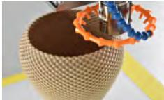
熱で溶かした材料を一層ずつ積層し造形する3Dプリンターで作られています。製造時の廃棄物が無く環境にやさしい製法です。
