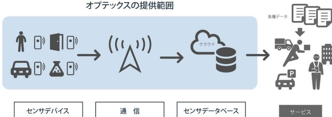
・通信方式：LPWA\*（SIGFOX、LoRa など）、3G/LTE、Bluetooth、サブギガ通信（EnOcean など）など、用途に応じて最適な手段を活用します
