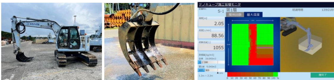
テノキューブ工法の施工機・掘削攪拌装置、および施工管理画面
