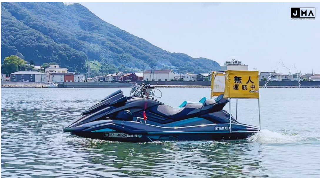
遠隔操縦システムを搭載した無人の特殊小型船舶
