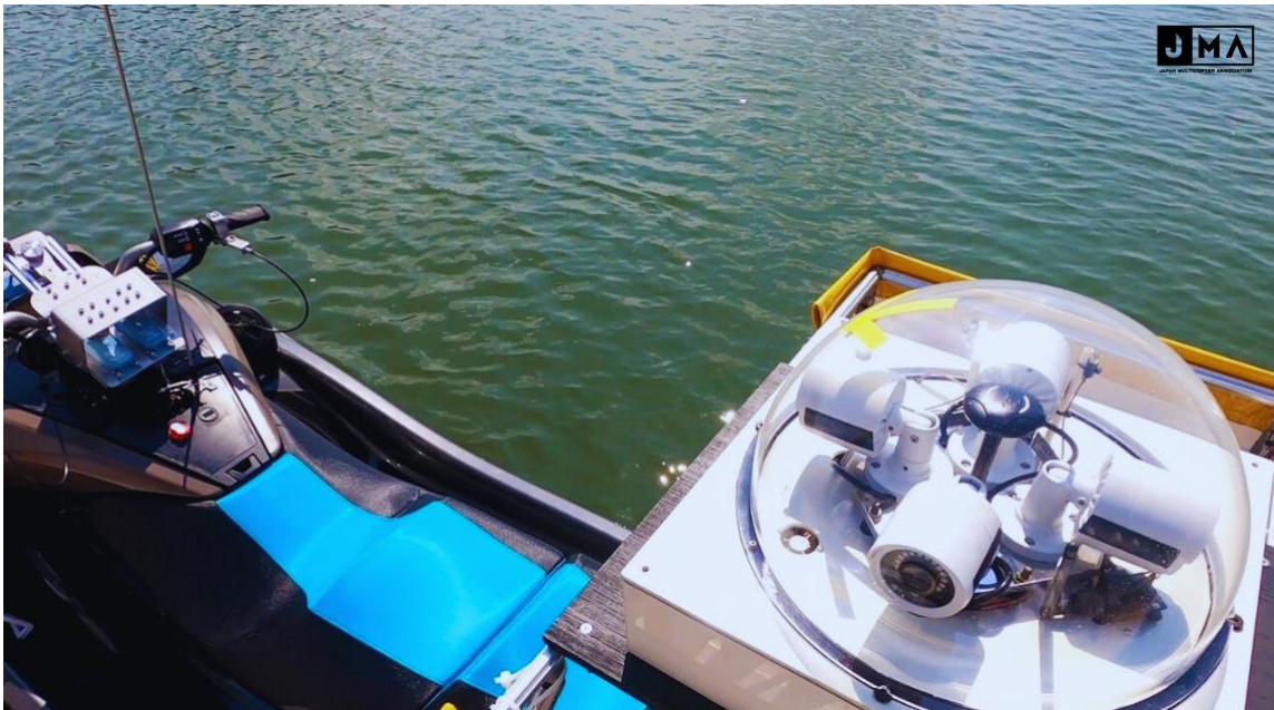
360度の視野角をカバーできる監視システム（右）と遠隔モジュール（左）
