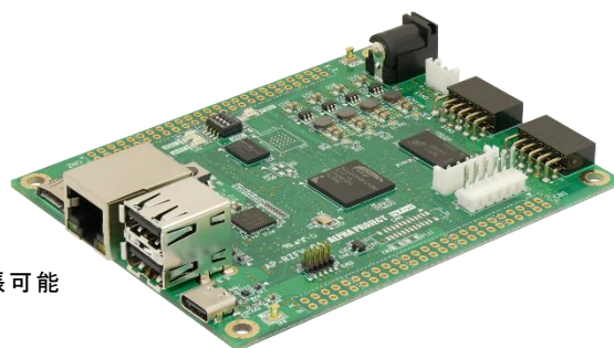
AP-RZFV-0A の外観 基板寸法: 100x80mm (コネクタ、突起物除く)
