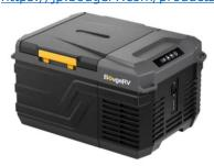
コンパクトなサイズで、トラックやトレーラーの運転室、小型車のトランクにも簡単に収納することが可能。急速冷凍機能を搭載しており、20℃~-20℃の範囲で温度調整が可能なコンプレッサー式ポータブル冷蔵庫です。25℃から-20℃までの降温にわずか40分しかかからず、入れた食品を最も新鮮な状態に保つことができます。
