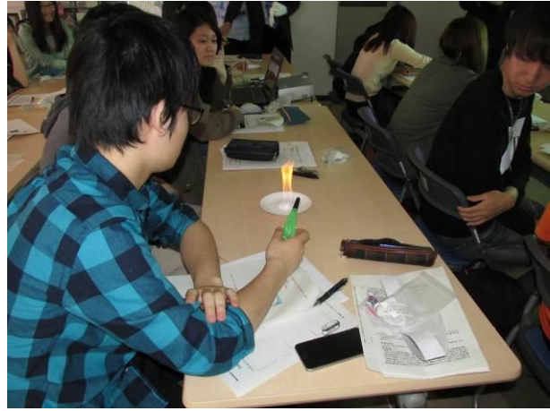
メタンハイドレートの燃焼実験
