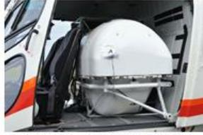
空中重力偏差法探査装置
