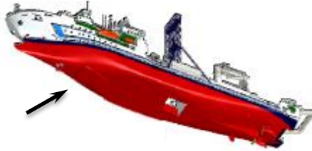
調査船「白嶺」の船底に取り付けられた マルチビーム音響測探機
