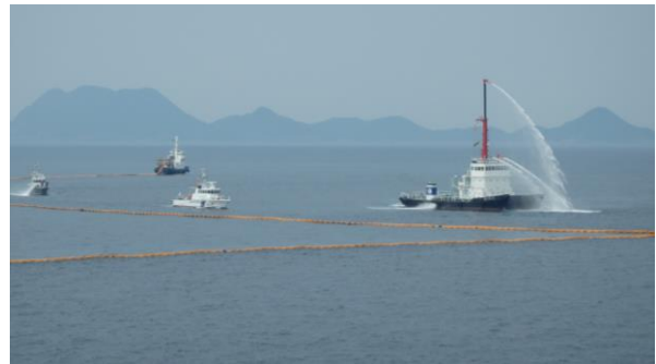
流出油防除訓練(放水攪拌・可燃性ガス検知)
