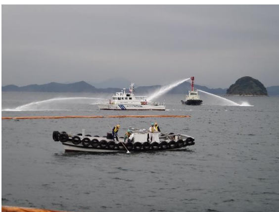
流出油の回収と浮流油の拡散処理
