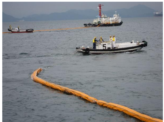
オイルフェンス第1線・第2線の展張
