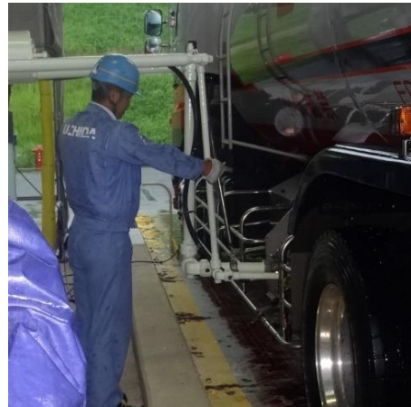
九州液化瓦斯福島基地(株)での タンクローリーへのガス充填(想定)
