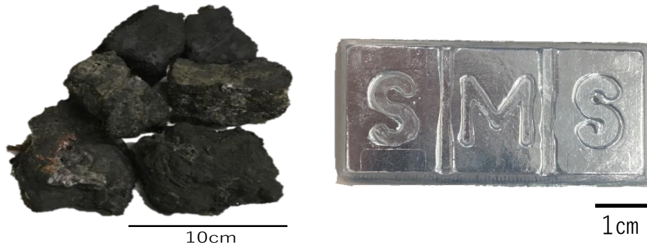
海底熱水鉱床の鉱石(左)および製錬所で製造した亜鉛地金(右)
