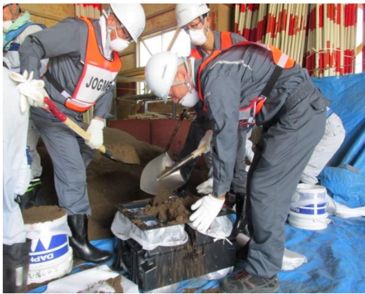
土のう製作機使用状況②
