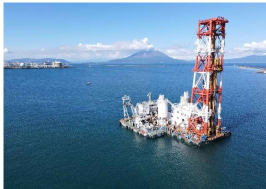
環境対応型 深層混合処理船 【DCM6号船】
