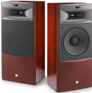
JBL 伝統のユニット構成である380mm径ウーファーと50mm径コンプレッション・ドライバーの2ウェイ構成を基に、超小型19mm径コンプレッション・ドライバーを超高域拡張用として組み合わせた3ウェイ構成。
