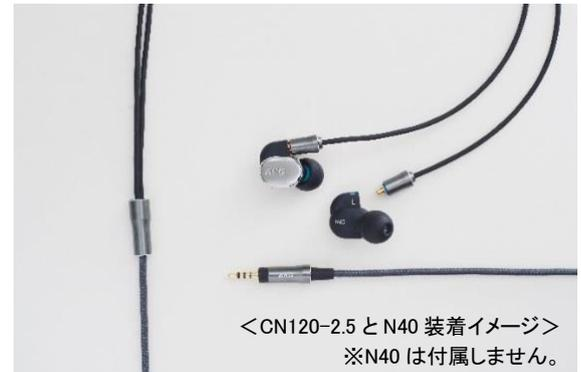
N40とN30のために新開発したケーブルは、入力端子がφ2.5mmで、ノイズに強いバランスケーブルの「CN120-2.5」と、入力端子がφ3.5mmで、汎用性が高いアンバランスケーブルの「CN120-3.5」の2種類で、お持ちのプレーヤーに応じてお選びいただけます（出力端子はMMCX端子）。いずれのケーブルも取り回しがしやすい長さ1.2mのストレートケーブルです。
