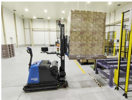
コンベアから完成品パレットを受け取る AutoFork
