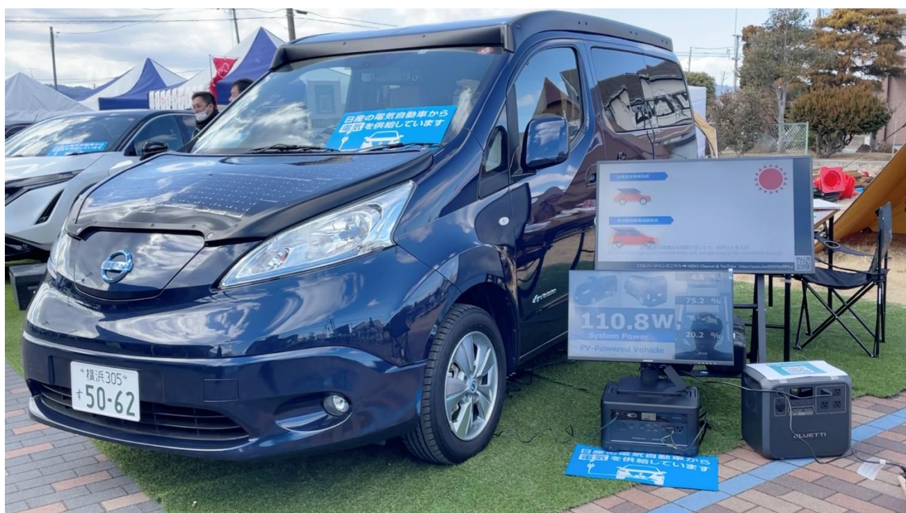
写真：日産自動車エリア 日産 e-NV200 をベースに太陽光パネルを後付け搭載している研究開発用ソーラーEV
