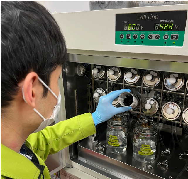
《JIS K 6953-2 (ISO 14855-2) に基づくコンポストを用いた生分解性試験設備》
