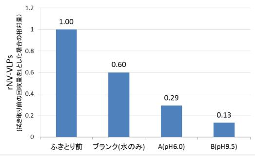
rNV-VLPs をステンレス製プレートに塗布し、担体上を各検体で一定の動作で拭き取り、拭き取り性能を評価した。 水のみを不織布に含浸したブランクに比べて、rNV-VLPs が除去されており、拭き取り効果が高いことが示された。
