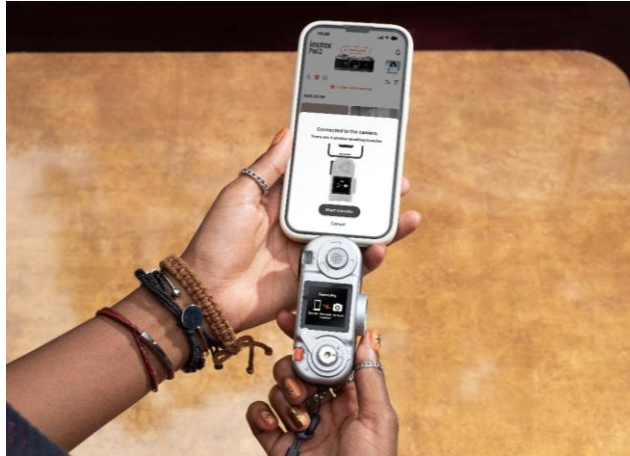
カメラ本体の Type-C 端子でスマホと直接接続
