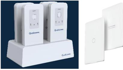
トラックデバイスとクレジットカード型デバイスの2種を展開しています。輸送状況の監視（現在の貨物位置確認、到着予定日時確認）、品質管理（温度管理にて腐敗や廃棄の防止）、品質エビデンス（データ蓄積による品質証明）、盗難防止（光センサーによる開封検知）が可能です。
