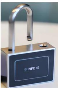
バッテリー不要でロック制御（モーター駆動）できるICを搭載し、スマホからNFC（近接無線）で電源を供給することで、鍵の開け閉めが可能となります。
