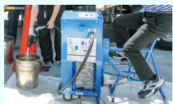
ペダルをこくとノズルから燃料が出てきます
