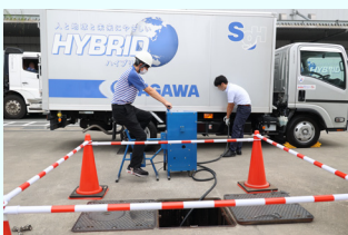
ペダルをこくとノズルから燃料が出てきます
