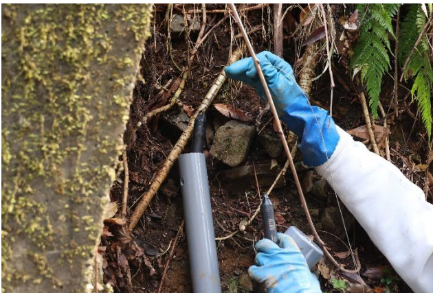
塩ビパイプに入れた黒いセンサーで 水圧と大気圧を計測する
