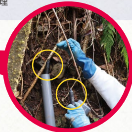
パイプの中のセンサーで水圧と大気 圧を計測し、河川流量を測定します
