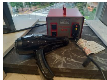
変圧器で電圧の違うドライヤーを使用
