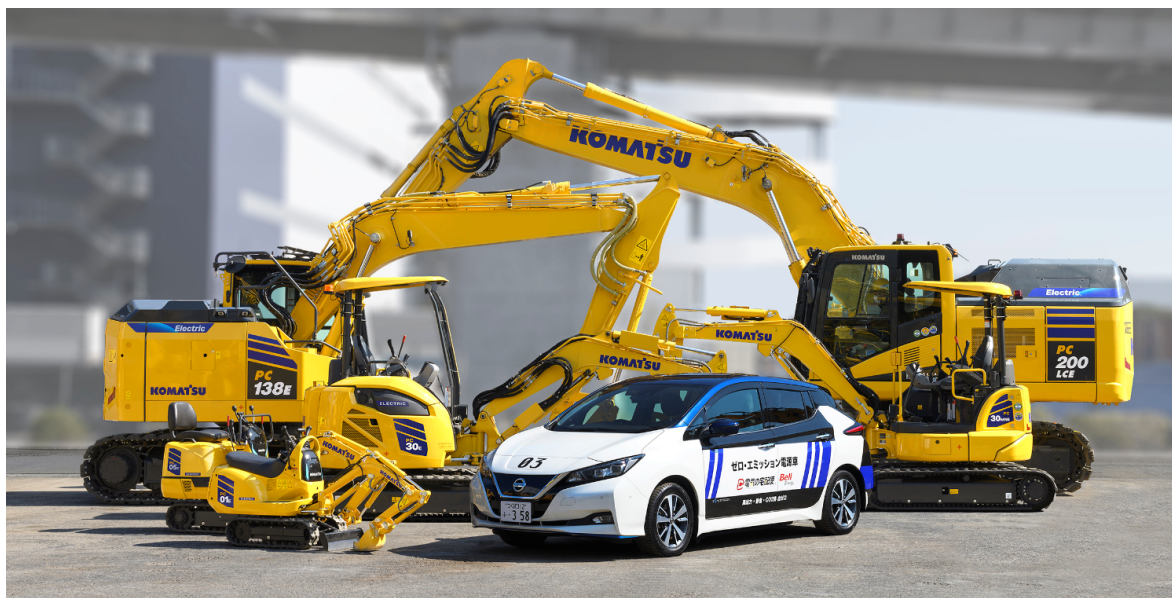
【MESTA Gen（中央）とコマツのバッテリー式電動ショベル 6 機種】
