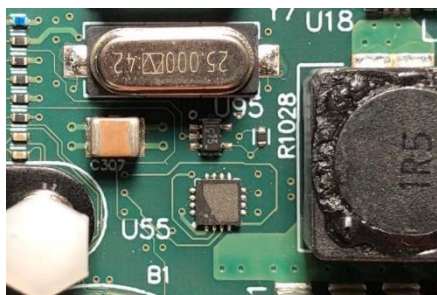
偽造品に搭載されている不明パーツ (U55)。 チップ上部のマーキングが消されている。
