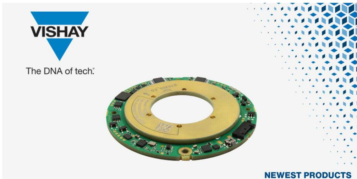
マウザーで取り扱う、Vishay の [RAIK060](#) エンコーダは、最大 10,000 rpm の回転速度と 5 $\mu$ s 以下の低遅延時間を実現し、モータードライブの計算処理を高速化します。[位置センサ](#) の繰り返し精度は 17 ビット以上、全体精度は 13 ビット、エンコーダの分解能は 18 ビットに設定されています。また、信頼性を高めるため自己監視機能を搭載し、電源オフ前の最終位置を記憶する機能を備えています。出力インターフェースには SPI、SSI、BiSS-C があり、シングルターンおよびマルチターンから選択可能です。その他の特長として、自己校正機能の搭載、有効な 360° 電気機械角、ステータス LED の色による簡単な組み立て調整などが挙げられます。
