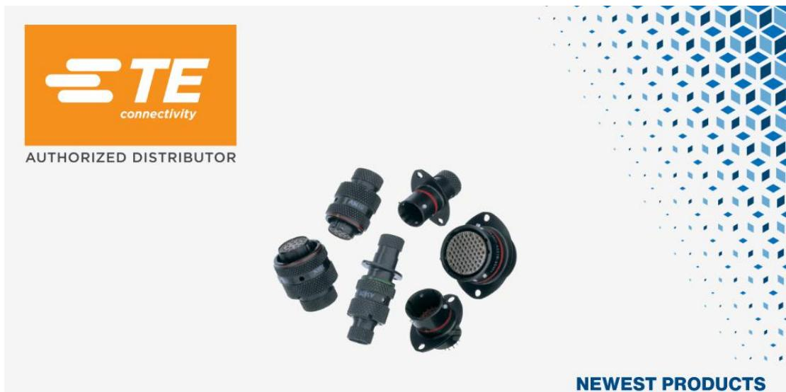
マウザーで取り扱いを開始した TE の [Wildcat](#) コネクタは、複数のハウジングサイズ、コントラクト配置、嵌合方式をラインアップしており、スペースに制約のある幅広いアプリケーションに対応します。Wildcat シリーズは、握りやすい嵌合リングとトリプルスタートスレッドを採用しており、高密度設計においても迅速かつ確実な嵌合および離脱を可能にします。また、本コネクタはブラック亜鉛ニッケルめっきを施しており、熱サイクル試験を実施済みです。嵌合時には IP67 の環境保護性能を備え、[過酷な環境下](#) でも高い信頼性を発揮します。
