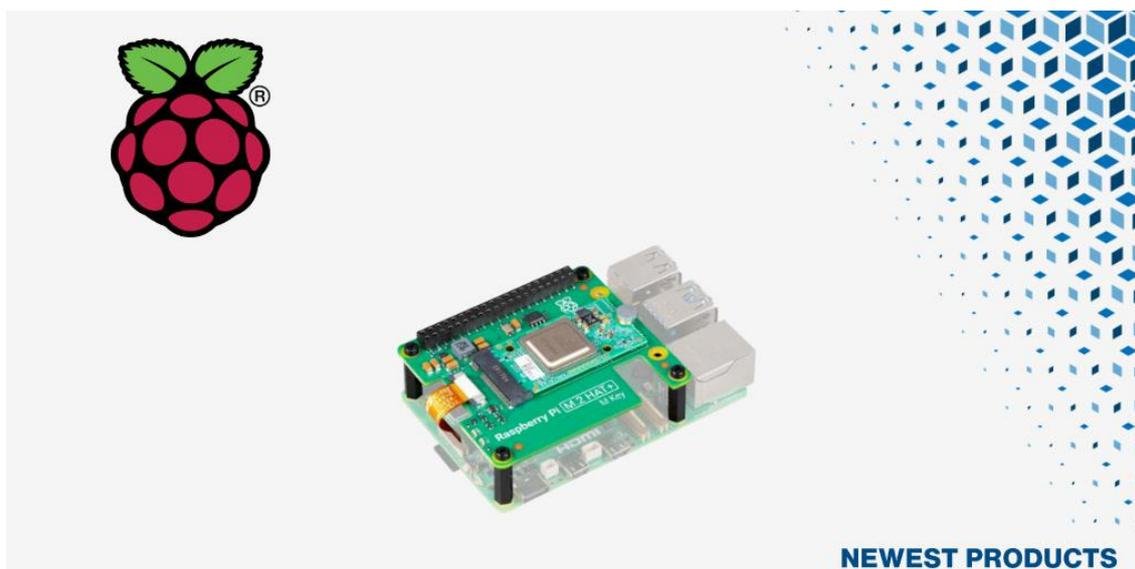
マウザーで取り扱う、Raspberry Pi の [Hailo 8L](#) AI キットは 13 TOPS (1 秒間に 13 兆回の演算) のニューラルネットワーク推論アクセラレータで、Hailo 8L チップを基盤としてい
